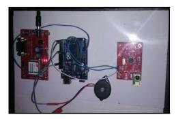
Fig. 3: GSM module
